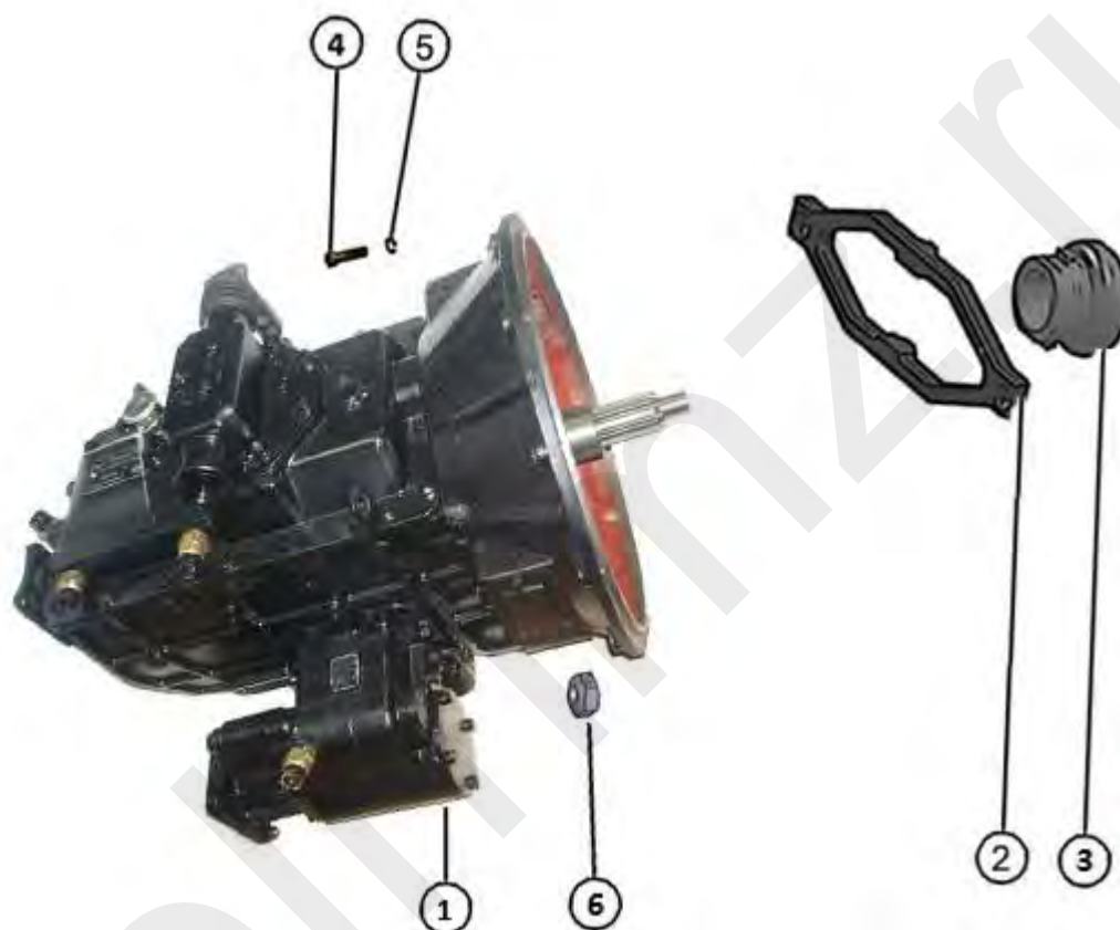
Рис. 20 Установка привода и картера муфты сцепления.
